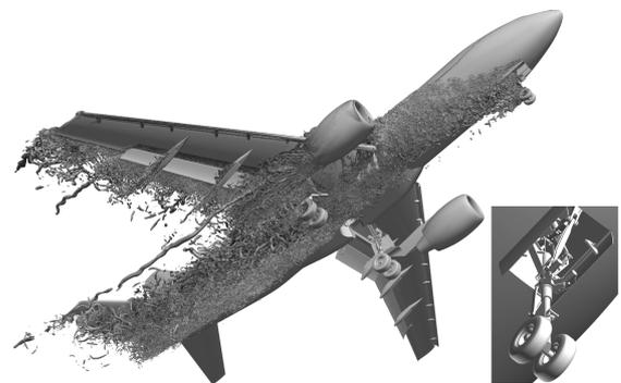
図2 航空機離着陸時複雑形状周りのLES解析。Q値の等値面により乱流渦を可視化。
